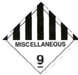
Kennzeichnung mit Gefahrzettel-Nr. 9 für große Lithium-Metall- und Lithium-Ionen-Batterien
